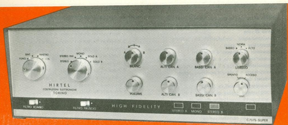
Fig. 8 - Da questa illustrazione, in cui è riportato l'amplificatore a montaggio ultimato, è chiaramente visibile l'ordinata disposizione dei numerosi comandi installati sul pannello frontale del complesso.
